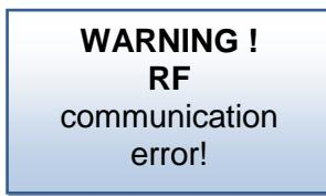
Diese Nachricht wird gesendet, falls sich die Kommunikation zwischen der Zentraleinheit V24 und der RF-Antenne des GSM Moduls verliert.
