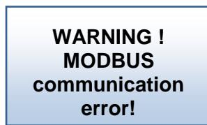
Ce message sera envoyé s'il y a perte de communication BUS entre le module GSM et la centrale V24 soit entre l'antenne et le module GSM pour la version sans fil.
