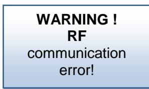
Este mensaje será enviado en el caso de la pérdida de la comunicación entre la unidad central V24 y la antena RF del módulo GSM.
