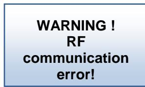
Ce message sera envoyé s'il y a perte de communication RF entre l'antenne du module GSM et la centrale V24.
