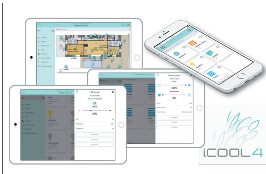
Obr. 3. Mobilní aplikace iCOOL4 pracuje nad systémem Foxtrot umístěným v rozvaděči a integruje v domě v Omicích všechna nainstalovaná zřízení do jednoho místa. Odtud je jejich provoz automatizován, koordinován, optimalizován a regulován. Zároveň si z aplikace uživatel sám nastaví své dlouhodobé priority pro jednotlivé místnosti a zařízení, volí režimy domu ovlivňující najednou všechny technologické součásti nebo zasáhne ručně s nejvyšší prioritou, jak uzná za vhodné v daném okamžiku.
