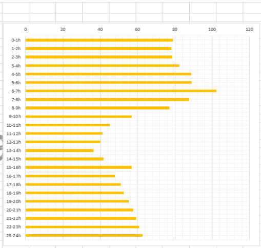
Obr.6 Hodinový souhrn spotřeby energie na vytápění pouze pro pracovní dny za prosinec 2016 (bez režimu útlumu)
