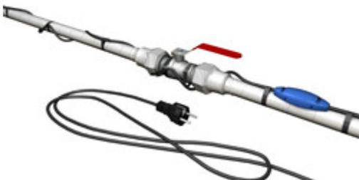
Das Kabel in seiner ganzen Länge mit Aluminiumband zur Rohrleitung befestigen und mit Wärmeisolierung versehen
